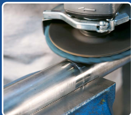
Broušení lehkých svárů a odstraňování teplotního zabarvení
