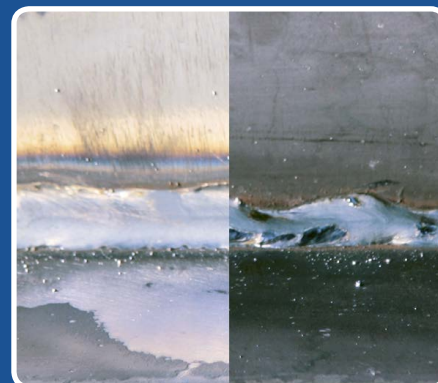
Odstranění okují před broušením a leštěním svárů
