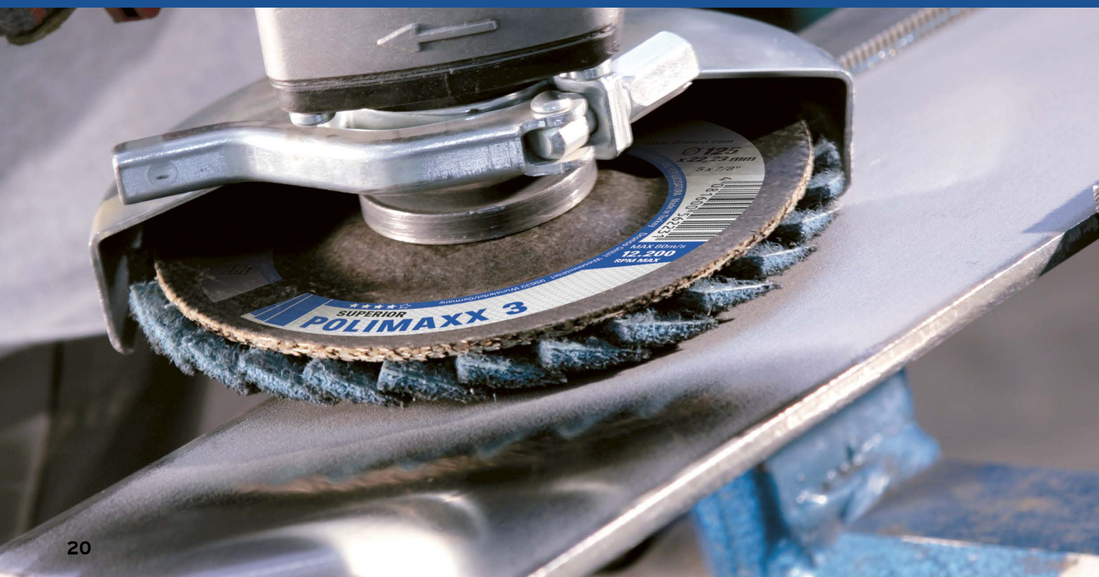
Broušení lehkých svárů a odstraňování teplotního zabarvení
